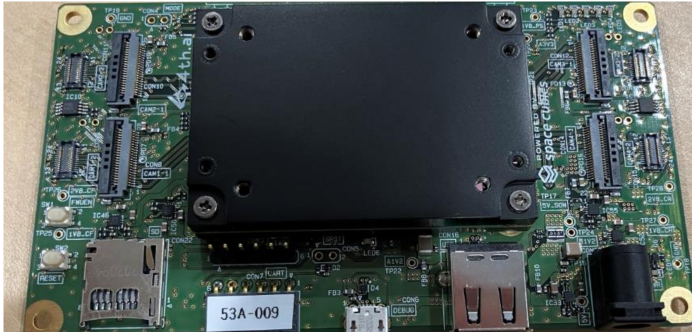
自社開発のFPGA搭載ECU
